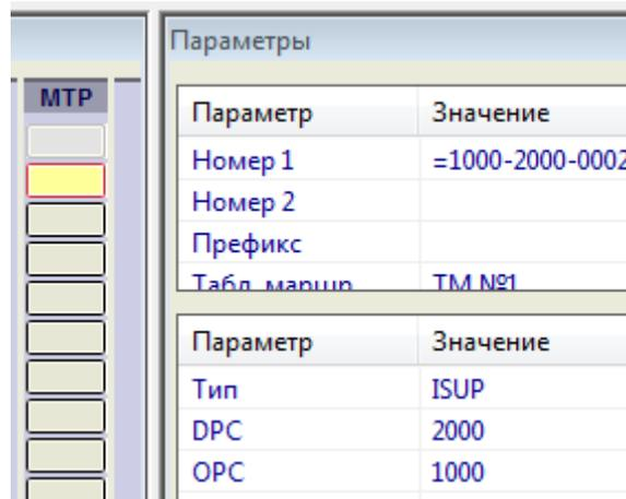
Важным значением является **СIC** канального интервала – его номер в пределах заданного направления ОКС. **СIC** настраивается с помощью параметра **Номер 1**.
